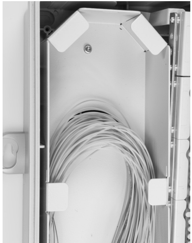
4.2 De blæste fibre skal fremføres i højre side frem til markeringsåbningen i overlængdeboksens bunden før de drejes ned i venstre side.
